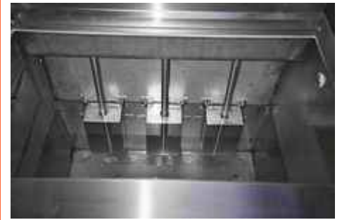
Lavaggio stampi per materie plastiche di precisione per industria, modellismo e giardinaggio. Nella foto i nostri potenti trasduttori IMMERSIBILI in acciaio inox 316 L, serie ULTRAPIEZO HIGH-POWER
